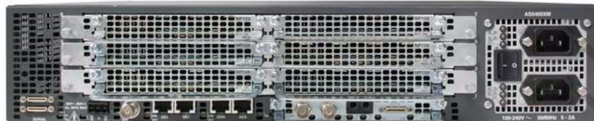
図 2 Cisco AS5400XM ユニバーサル ゲートウェイのシャーシ
