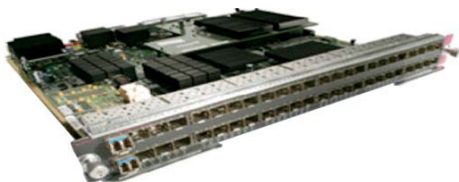
図5 6800シリーズ48ポート10/100/1000インターフェイス銅線モジュール WS-X6848-TX-2T/2TXL
