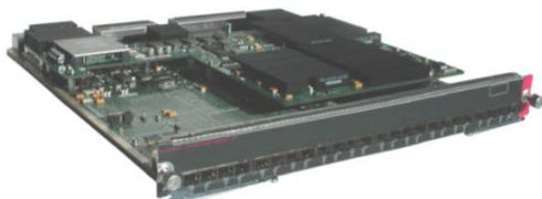
図4 6800シリーズ48ポートギガビットイーサネットインターフェイスモジュール WS-X6848-SFP-2T/2TXL
