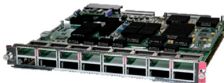
図 1 6800 シリーズ 16 ポート 10 ギガビット イーサネット ファイバ モジュール
