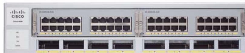
図 3 ワイヤスピード (オーバーサブスクリプションなし) で 40 ポートの 10/100/1000 イーサネットをサポートできる Catalyst 4900M
