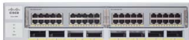
図 4 ワイヤスピード (オーバーサブスクリプションなし) で 40 ポートの 10/100/1000 イーサネットをサポートできる Catalyst 4900M
