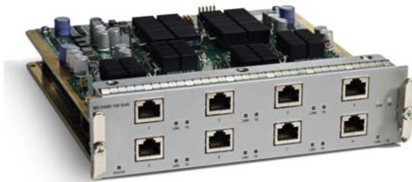
図 5 8ポート(2:1)10GBASE-T RJ-45 ハーフカード 1 (1G/10G で動作可能、最大 100 m の Cat 6a/Cat 7 ケーブル)
