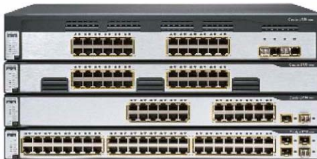
図 2 StackWise および StackWise Plus テクノロジーを使用する Cisco Catalyst 3750-E シリーズ スイッチのスタック
