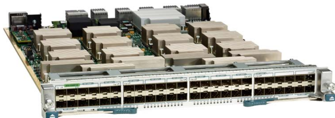
図 2 Cisco Nexus 7000 F2 シリーズ 48 ポート 1/10GbE SFP/SFP+ モジュール
