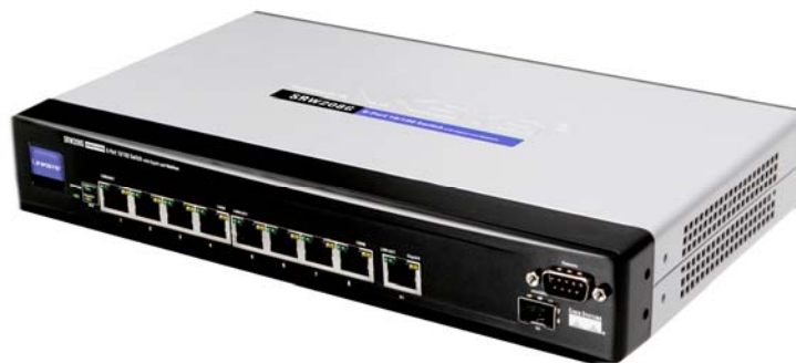
Abbildung 1. Cisco-10/100-Ethernet-Switch SRW208G mit 8 Ports: WebView/Erweiterungssteckplätze
