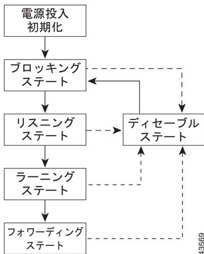
デフォルト設定では、スイッチを起動するとスパニングツリーがイネーブルになります。その後、スイッチの各インターフェイス、VLAN、ネットワークがブロッキング ステートからリスニングおよびラーニングという移行ステートを通過します。スパニングツリーは、フォワーディング ステートまたはブロッキング ステートで各インターフェイスを安定させます。
