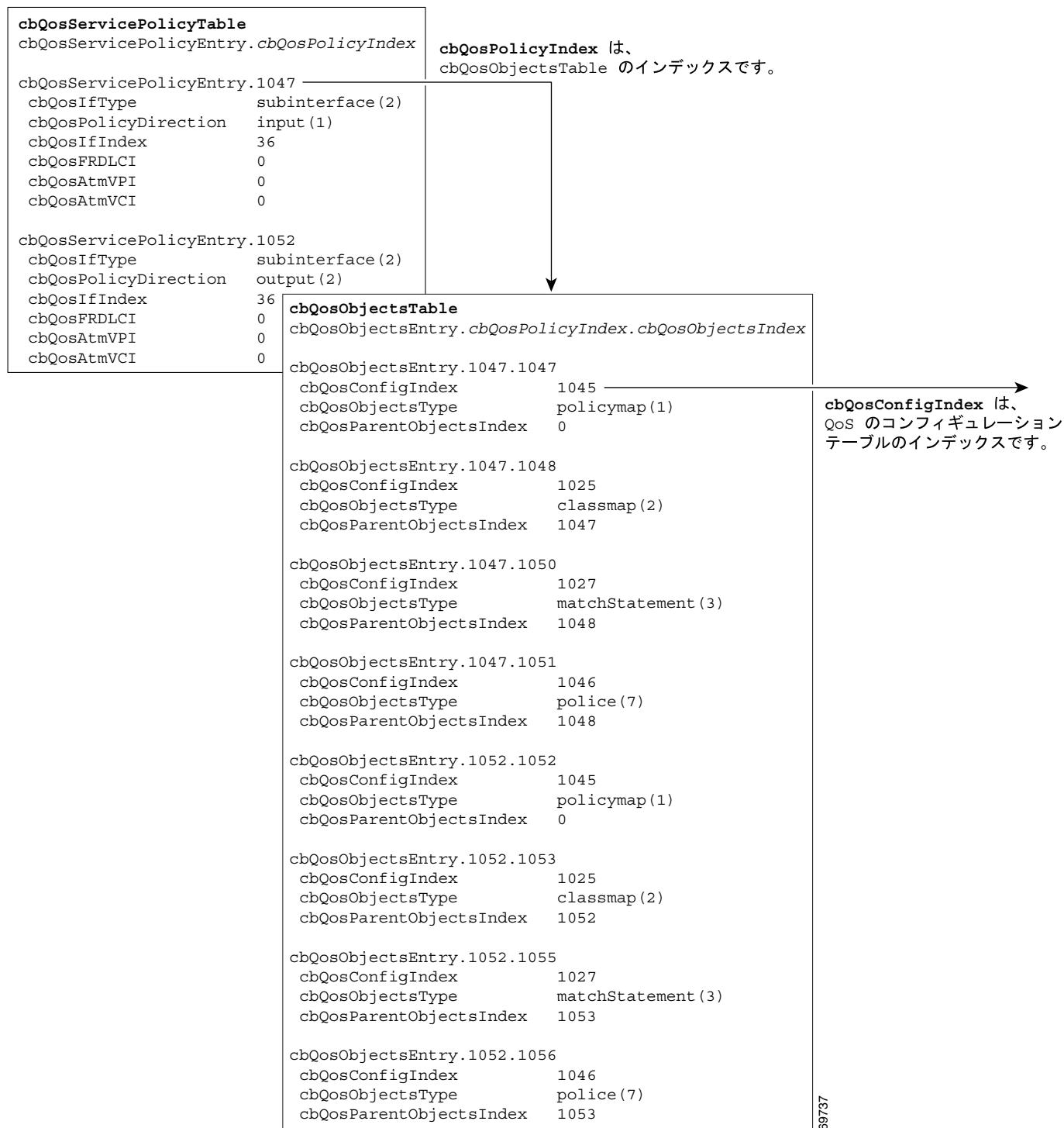
図 A-9 GigabitEthernet QoS — サービス ポリシーおよびオブジェクト テーブル
