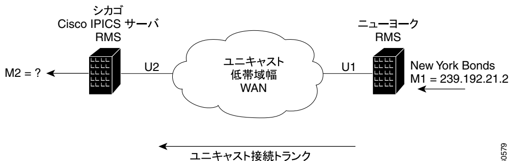
図 7-8 M1:U12:M2 接続トランク
