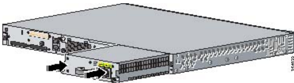
Figure 5 Insertion d'une alimentation CA dans un système d'alimentation redondante RPS 2300
