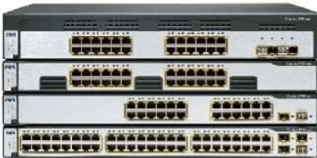
Figure 1. Pile de commutateurs Cisco Catalyst 3750 utilisant la technologie StackWise
