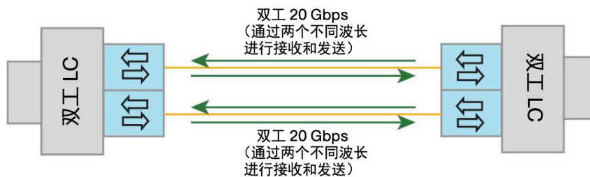
图 27. Cisco BiDi 光纤连接和速度
