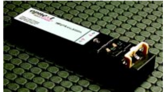
上图是由 opnext 公司所生产的 STM16 可插拔光电转换器。
