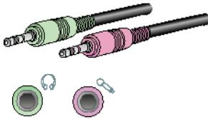
Los auriculares analógicos funcionan con la tarjeta de sonido del equipo y no requieren controladores de dispositivos.
