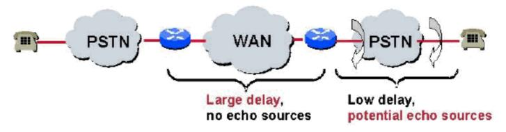
封包語音造成的延遲是不可避免的。因此,語音網關必須阻止回聲。此圖說明閘道如何在可以使用 回聲消除器進入封包語音網路之前減少回聲。
