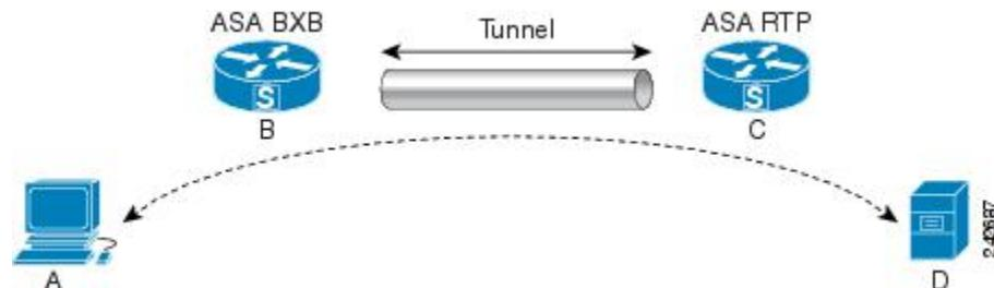
在此示例中，BXB 和 RTP 网络通过一对安全设备，经由安全的 LAN 间隧道进行连接。BXB 网络中的 PC 正经由安全隧道，通过 RTP 网络中的服务器执行 FTP 传输。在此场景中，假设在 PC 登录至服务器并开始传输后，出于某些原因，隧道丢弃。尽管隧道会因为数据仍在尝试流动而重建，FTP 传输却不会完成。用户必须终止传输，并通过重新登录至服务器来重新开始传输。然而，如果启用了持续 IPsec 隧道，一旦隧道在超时间隔内被重建，数据会继续成功流过新的隧道，因为安全设备会保留该流量的历史记录（状态信息）。
