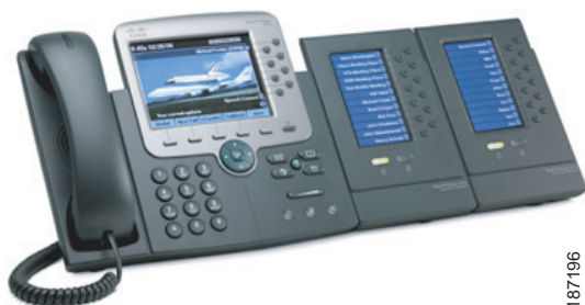
図 1 拡張モジュールを 2 台取り付けた Cisco Unified IP Phone 7975G
