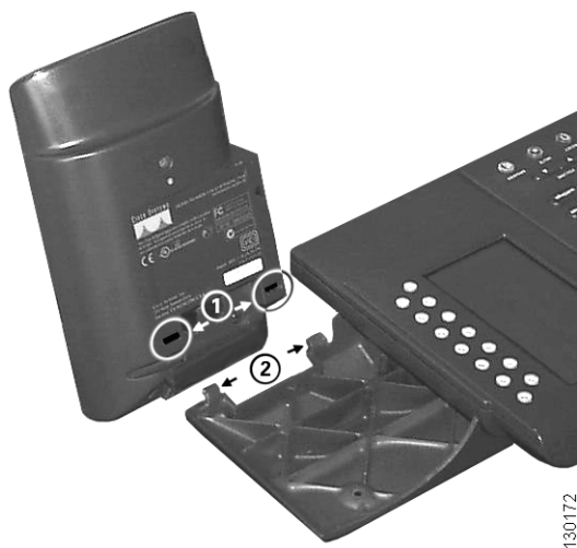
図4 サポートバーへの拡張モジュールの取り付け
