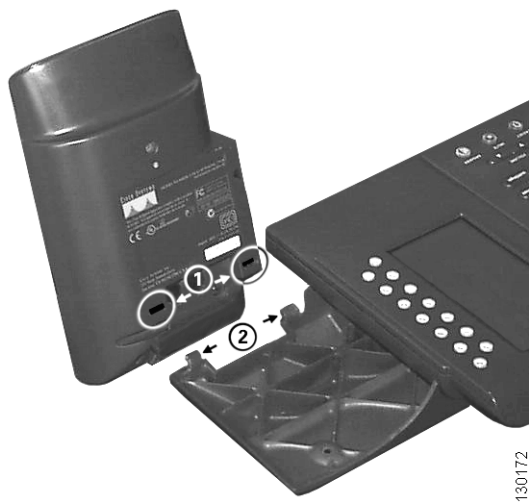
図 4 拡張モジュールの取り付け
