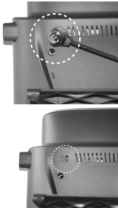
図 3-3 ケーブルロックの Cisco Unified IP Phone 7962G/7942G への接続
