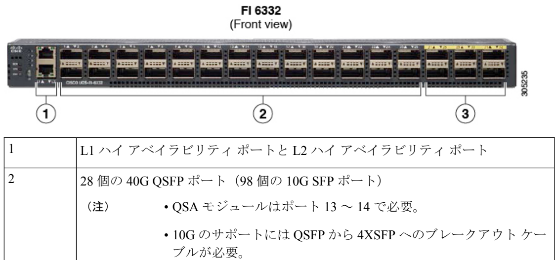
図 3: Cisco UCS 6332 シリーズ ファブリック インターコネクットの正面図
