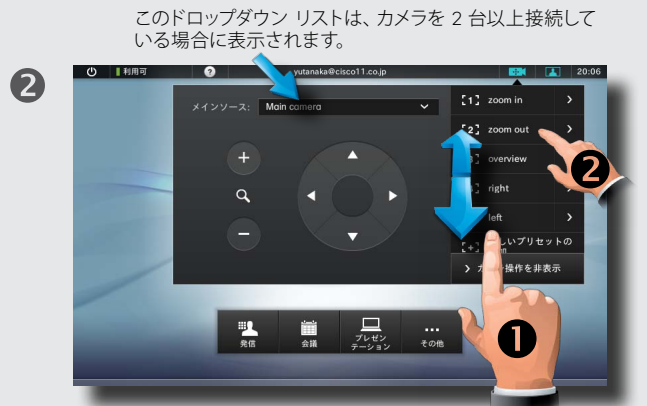
必要に応じてスクロールし、削除するカメラのプリセットを表示したら (1)、そのプリセットの > をタップして (2)、メニューを展開します。カメラを 2 台以上システムに接続している場合、カメラを選択できます。
