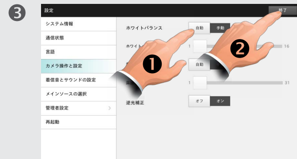
調整を行います。 [終了] をタップして、変更を有効にします。カメラを 2 台以上接続している場合、ここに表示される設定は、メインのカメラにのみ適用されます。そのカメラがソースとして選択されているかどうかは関係ありません。
