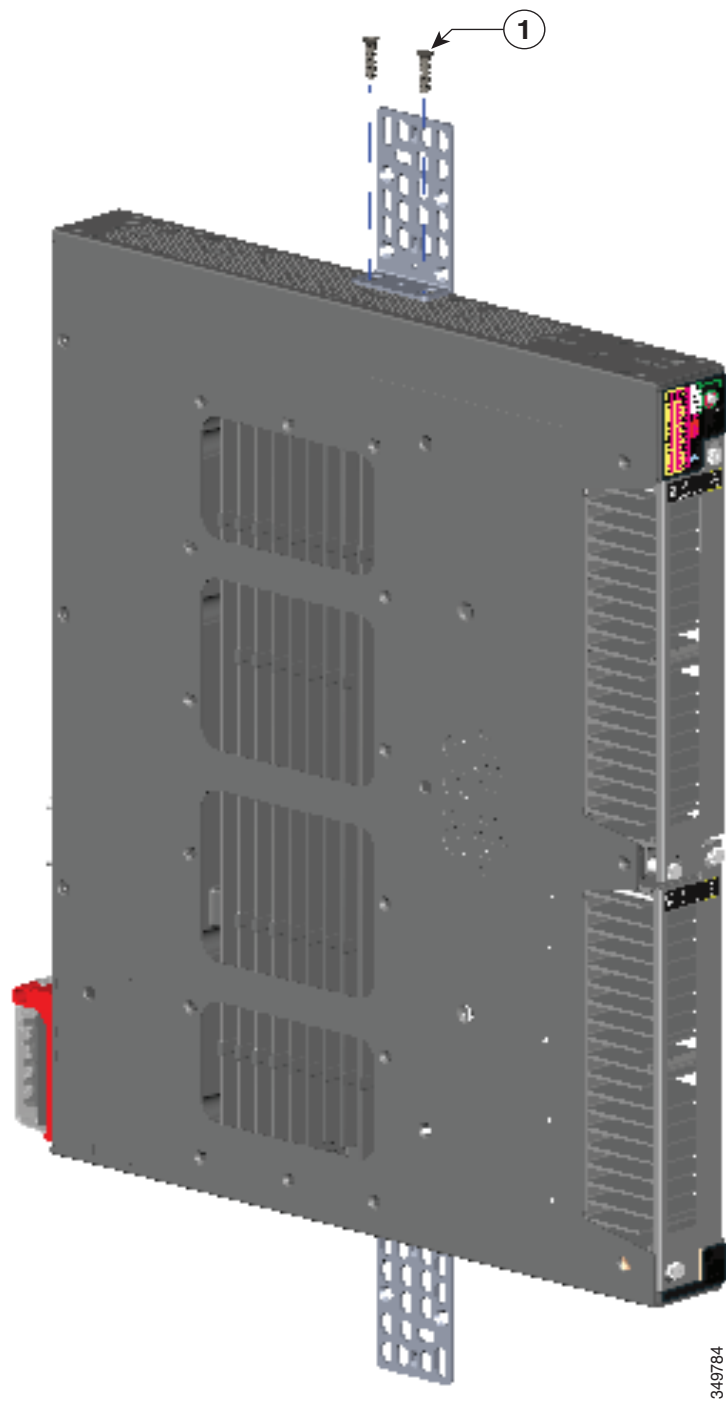
図 15 19 インチ ラック用の取り付け
