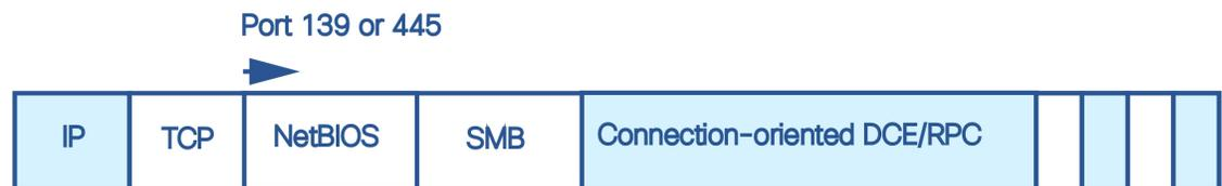
dce\_smb インспекタは通常、NetBIOS セッションサービス用のウェルノウン TCP ポート 139 か、または同様に実装されているウェルノウン Windows ポート 445 で SMB トラフィックを受信します。SMB には DCE/RPC の伝送以外にも多数の機能があるため、インспекタは SMB トラフィックが DCE/RPC トラフィックを伝送しているかどうかをまずテストします。伝送していない場合は処理を停止し、伝送している場合は処理を続行します。
