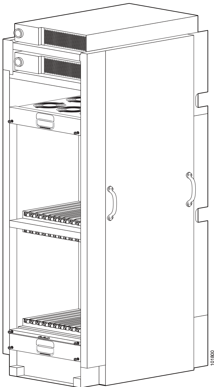
図 1-3 ラインカードシャーシの背面図
