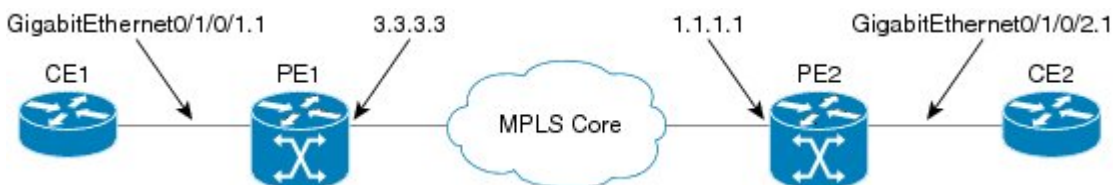
図 1: BGP 自動検出および BGP シグナリングを使用した VPLS
