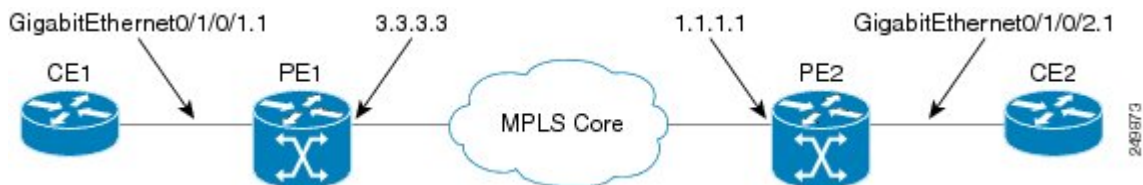
図 6: BGP 自動検出および BGP シグナリングを使用した VPLS
