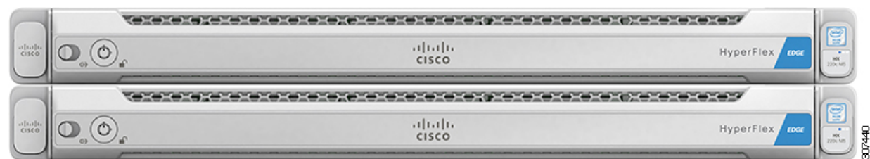
図 2: HyperFlex Edge (TOP01 および Intersight Witness を備えた 2 ノード)
