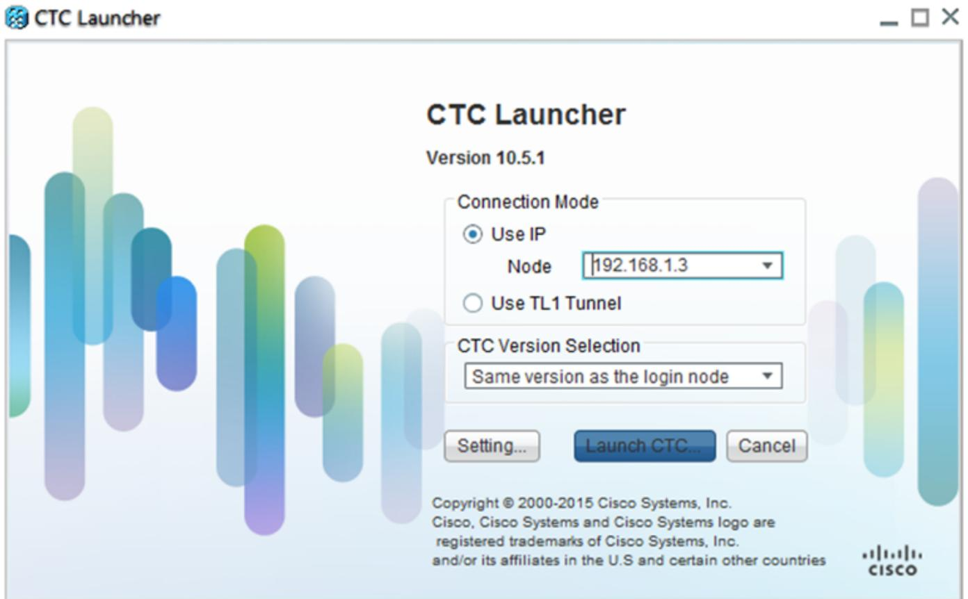
手順1.g. キャッシュを削除したら、CTC Launcherウィンドウの**Launch CTC**をクリックします。
