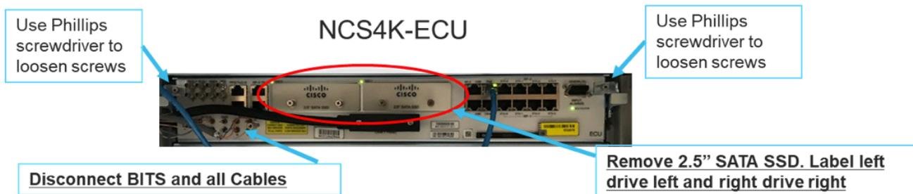
1.7.2. ECU2モジュールを取り付け、ケーブルを再接続します。
