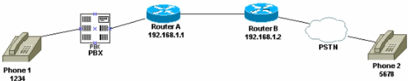
In questa figura, quando qualcuno prende il telefono 1, l'utente sente un segnale di composizione che proviene dal PBX. Il PBX ha un codice di accesso programmato per assegnare un canale al router. L'utente compone il codice di accesso e il numero di destinazione. Per questo esempio, si
