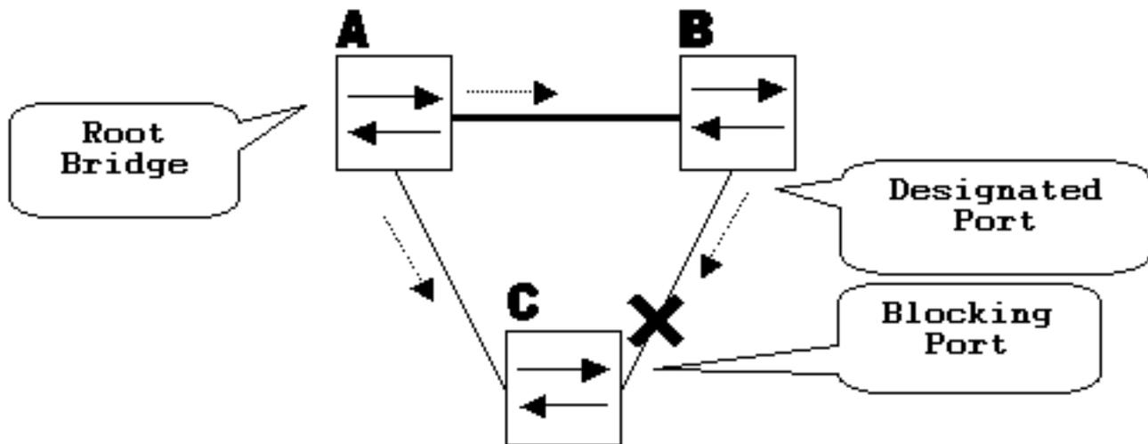
Im Normalbetrieb ist Bridge B ein designierter Port an der Verbindung B-C. Bridge B sendet BPDUs nach unten an C, wodurch der Port blockiert wird. Der Port wird blockiert, während C BPDUs von B für diese Verbindung erkennt.
