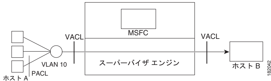
図 66-1 ブリッジドパケットへの ACL の適用
