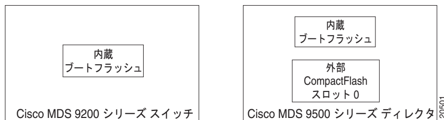
図 2-2 Cisco MDS 9000 スーパーバイザ モジュールのフラッシュ デバイス
