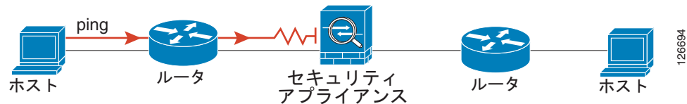
図 21-5 ASA のアドレス変換の問題による ping の失敗
