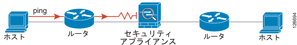
図 59-5 ASA のアドレス変換の問題による ping の失敗
