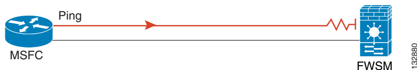
図 26-4 FWSM のルート未設定による ping の失敗
