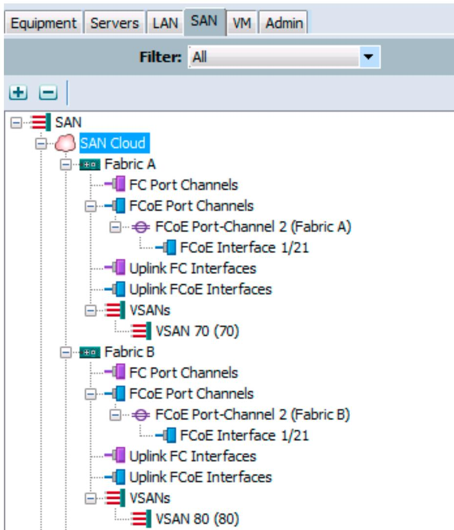
上一個示例顯示了UCS的視點。交換矩陣的每一端都有一個連線埠通道，編號為2（基於連線埠乙太網路1/21）。
