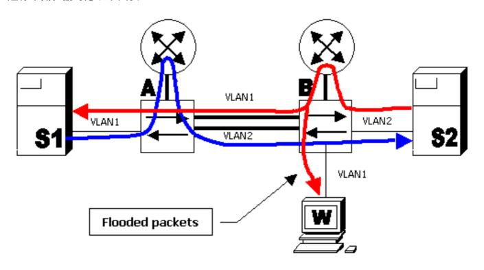
在上圖中,VLAN 1中的伺服器S1正在向VLAN 2中的伺服器S2運行備份(批次資料傳輸)。伺服器S1的預設網關指向路由器A的VLAN 1介面。伺服器S2的預設網關指向路由器B的VLAN 2介面。從S1到S2的資料包將遵循以下路徑:
