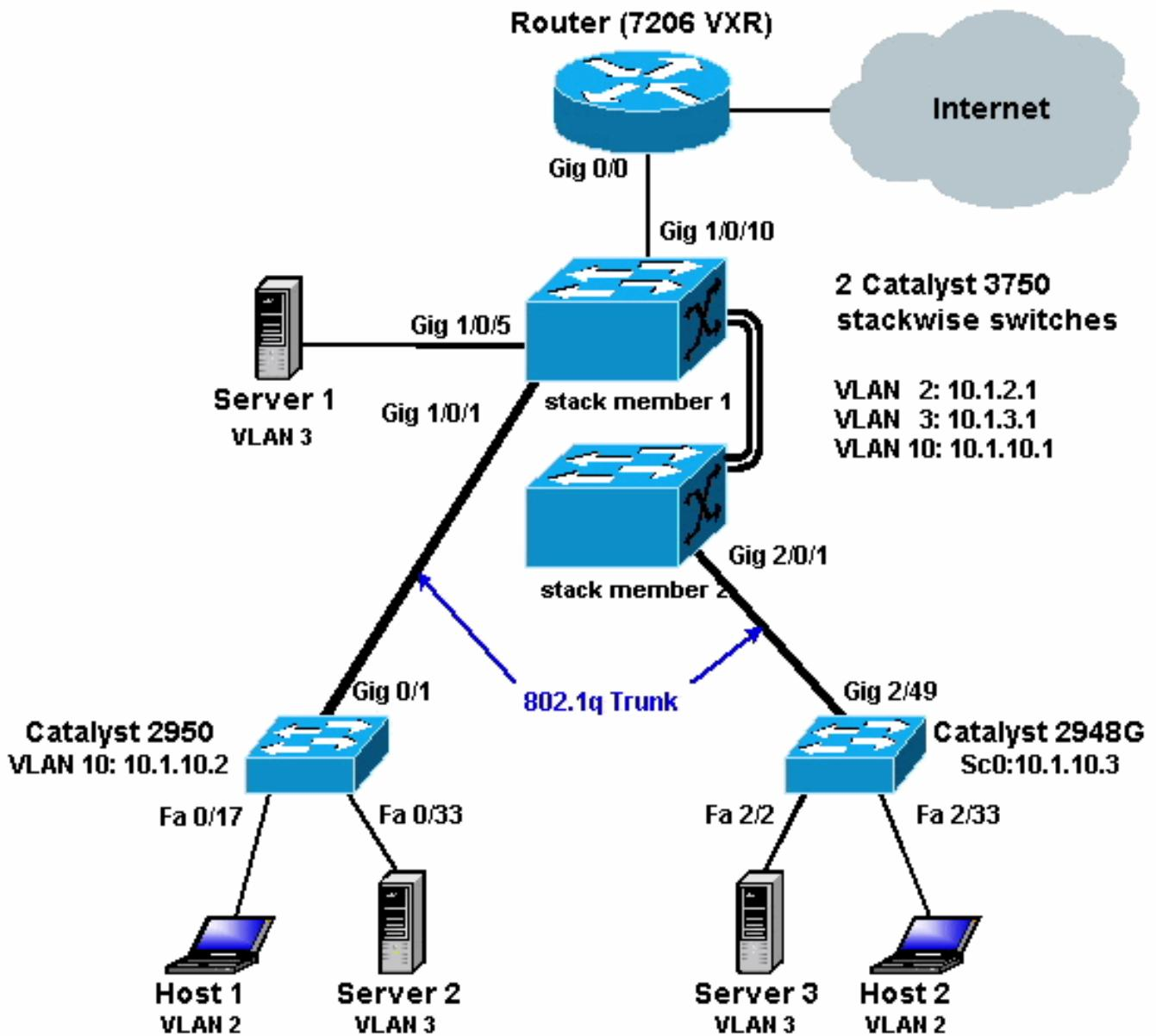
上圖顯示了一個小型的範例網路，其中包含Catalyst 3750堆疊，提供各個網段之間的VLAN間路由。
