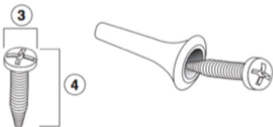
步驟5.擰緊每個螺釘，並在壁表面與螺釘頭部之間留出間隙。
