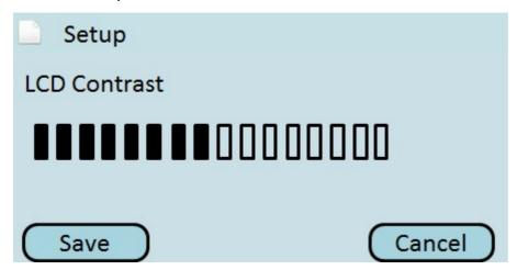
步驟2.使用左右導航按鈕將液晶屏對比度調整到最佳水準。
