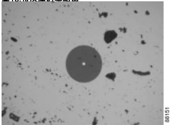
圖17:液體污染的聯結器
