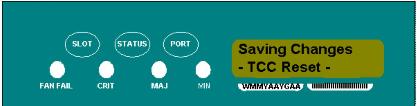
儲存新配置時，TCC卡將重新啟動。TCC卡重新啟動時，Saving Changes液晶屏出現幾分鐘。當LCD螢幕返回正常交替顯示模式時，程式完成。
