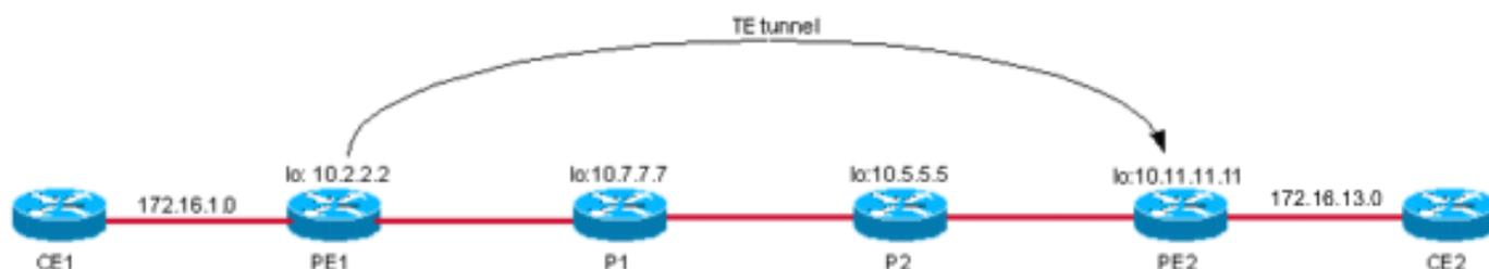
在使用自動路由通告的PE路由器之間構建TE隧道時，可通過TE隧道介面訪問出口PE BGP下一跳。因此，PE1使用TE標籤到達PE2。
