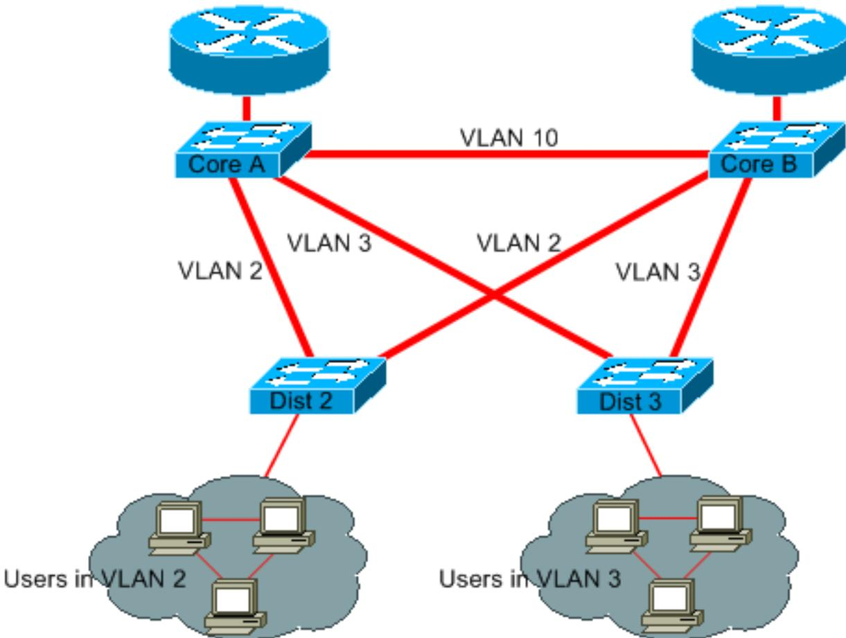
現在，核心A和核心B是一些第3層交換機。VLAN 2和VLAN 3不再在核心A和核心B之間橋接，因此不可能存在STP環路。
