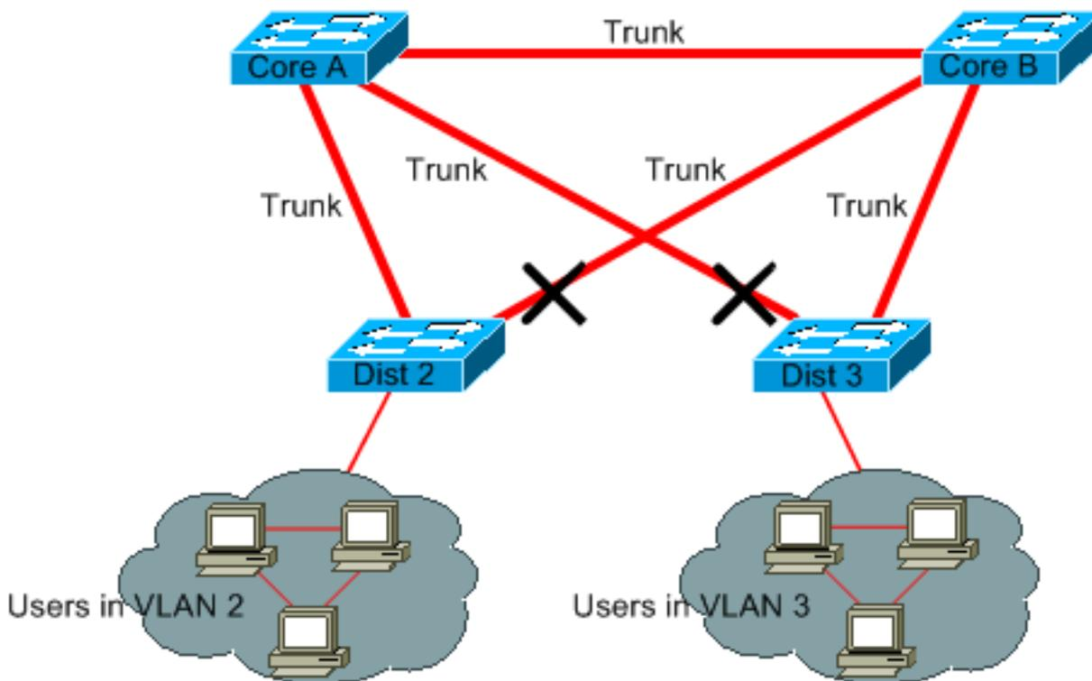
分佈層交換機與兩台核心層交換機採用雙連線。在分佈層交換機上連線的使用者僅位於網路中可用的VLAN子集中。在本例中，在Dist 2上連線的使用者都位於VLAN 2中；Dist 3隻連線VLAN 3中的使用者。預設情況下，中繼會承載在VLAN中繼線協定(VTP)域中定義的所有VLAN。只有Dist 2會收到VLAN 3的不必要廣播和多播流量，但它也會封鎖VLAN 3的一個連線埠。結果是核心A和核心B之間有三個冗餘路徑。這種冗餘導致埠阻塞較多，產生環路的可能性也較高。
