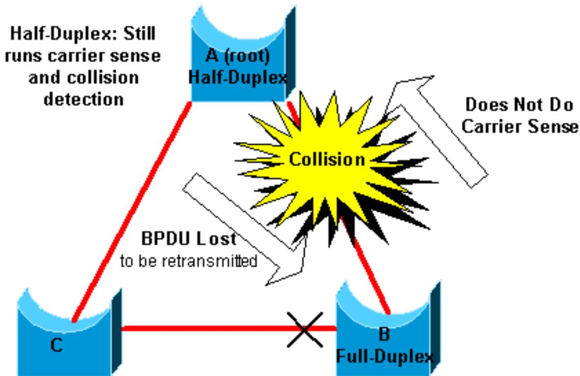
最糟糕的情況是，傳送BPDU的橋接器在連線埠上將雙工模式設定為半雙工，但連結另一端的對等連線埠將雙工模式設定為全雙工。在上一個範例中，橋接器A和B之間的連結上的雙工不相符很容易導致橋接回圈。由於網橋B具有全雙工配置，因此它不會在鏈路接入之前執行載波偵測。即使網橋A已使用該鏈路，網橋B也會開始傳送幀。這種情況對A來說是一個問題；網橋A檢測到衝突並在網橋嘗試再次傳輸幀之前運行回退演算法。如果從B到A的流量足夠，則A傳送的每個資料包（包括BPDU）都會發生延遲或衝突，最終會被丟棄。從STP的角度來看，由於網橋B不再從A接收BPDU，網橋B已丟失根網橋。這會導致B解除阻塞連線到網橋C的埠，從而形成環路。
