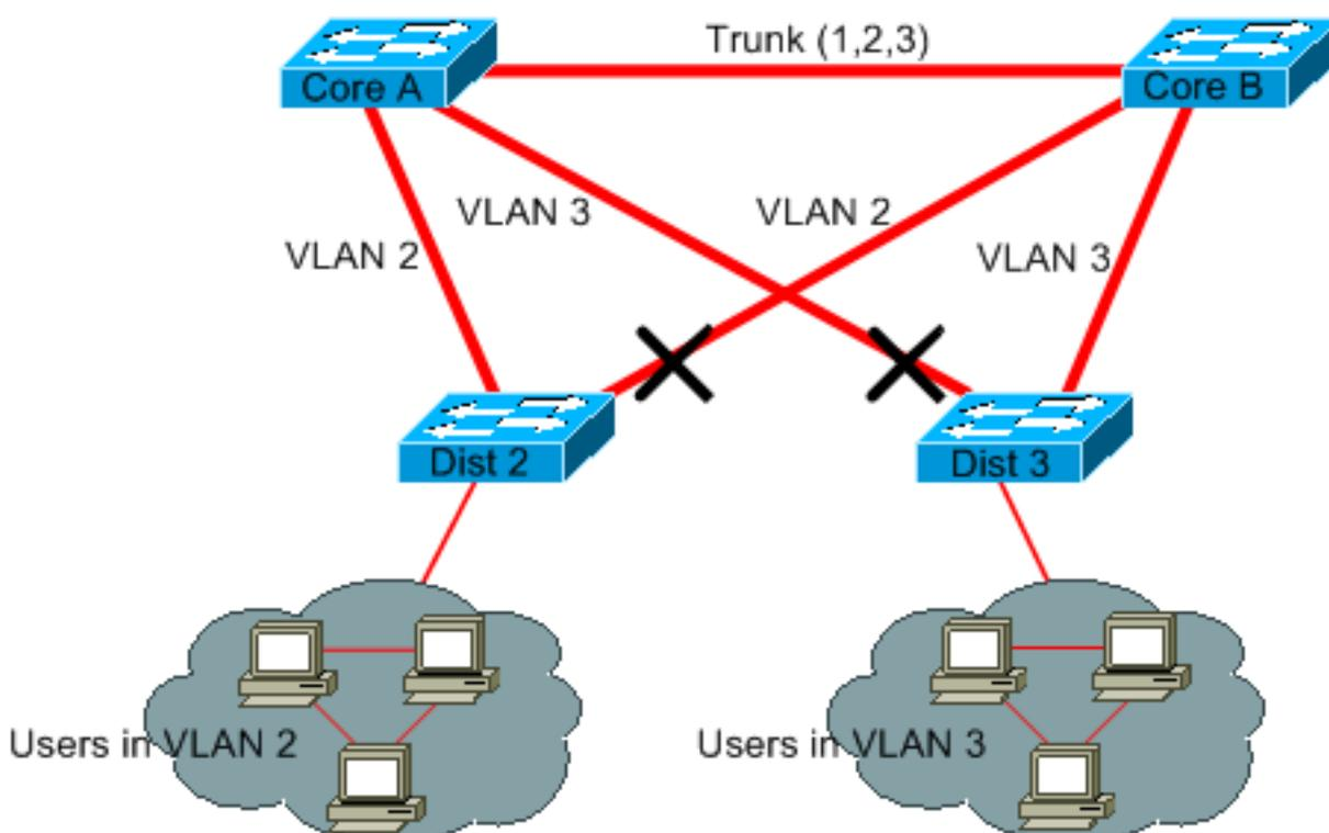
在此設計中，每個VLAN僅阻塞一個埠。此外，通過此設計，如果關閉核心A或核心B，只需一步即可刪除所有冗餘鏈路。
