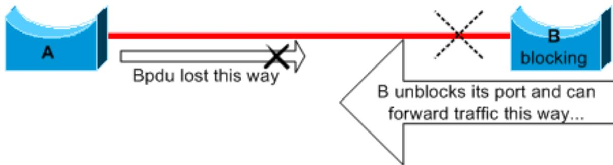
在這裡假設A和B之間的鏈路是單向的。當鏈路將流量從B傳輸到A時，鏈路會丟棄從A到B的流量。假設網橋B在鏈路變為單向之前阻塞。但是，如果埠從具有更高優先順序的網橋接收BPDU，則它只能阻塞。在本例中，由於來自A的所有BPDU都將丟失，因此網橋B最終會將其埠向A轉換到轉發狀態並轉發流量。這會產生環路。如果啟動時存在此故障，則STP無法正確收斂。在雙工不相符的情況下，重新開機暫時有幫助；但在這種情況下，重新開機絕對沒有效果。
