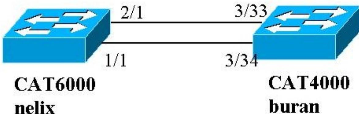
在本示例中，我們使用兩個千兆乙太網埠在Catalyst 4000和Catalyst 6000系列交換機之間配置LACP聚合鏈路，如上圖所示。
