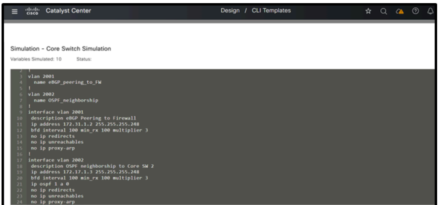
(2)核心交換機模板模擬輸入和輸出
