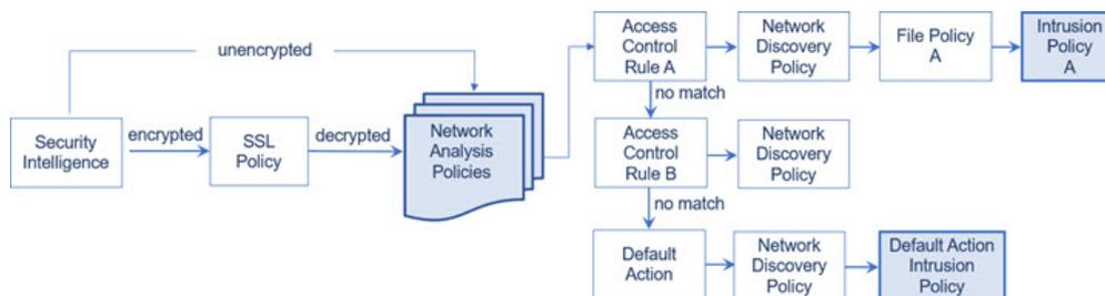
在内联部署中（即，使用路由接口、交换接口、透明接口或内联接口对将相关配置部署到设备），系统可以在图示过程中的几乎任何步骤阻止流量而不进行进一步检查。安全智能、SSL 策略、网络分析策略、文件策略和入侵策略均可以丢弃或修改流量。只有网络发现策略（被动检测数据包）无法影响流量的流动。
