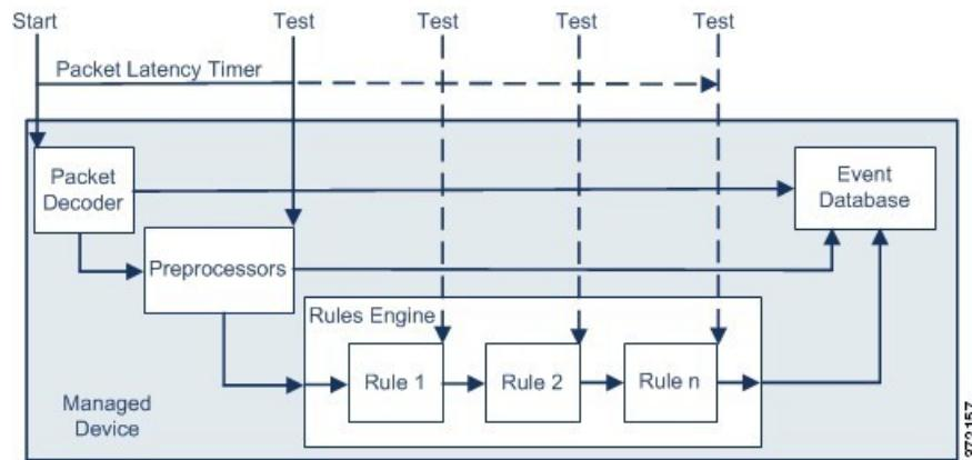
如上图所示，数据包延迟计时在以下测试点测试：
