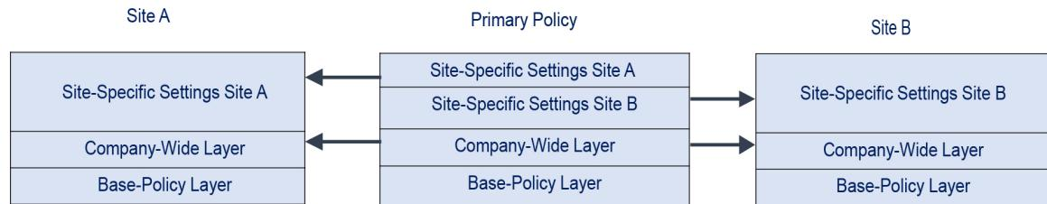
主策略中的公司范围层包含适用于站点 A 和 B 的设置。站点特定层包含特定于每个站点的设置。例如，如果使用网络分析策略，则 Site A 在受监控网络上可能没有 Web 服务器，并且不需要 HTTP Inspect 预处理程序的保护或处理开销，但两个站点均可能需要 TCP 数据流预处理。可在与两个站点共享的公司范围层启用 TCP 数据流处理，在与站点 A 共享的站点特定层禁用 HTTP 检查预处理器，在与站点 B 共享的站点特定层启用 HTTP 检查预处理器。通过编辑站点特定策略中的较高层配置，如果需要任何配置调整，您还可以进一步微调每个站点的策略。
